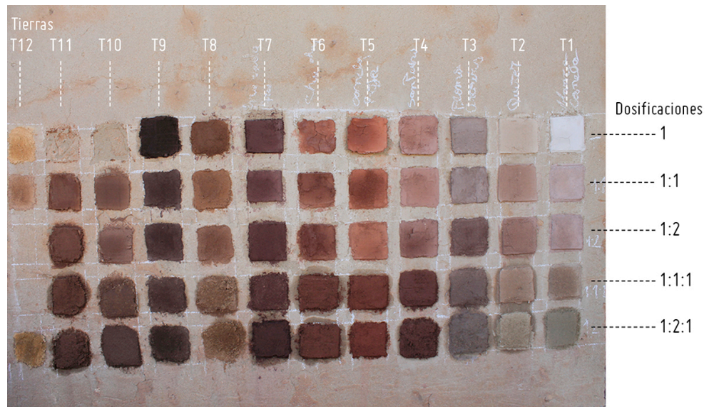
Figura 2. Prueba de colores y dosificaciones realizada con tierras extraídas de la localidad de Canela Baja, región de Coquimbo, Chile (crédito: Daniela Ignacia Vera, 2016)
